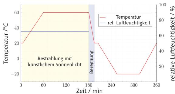
Abb. 1: Ein sechstündiger Zyklus der insgesamt dreiwöchigen Klimawechsellagerung
