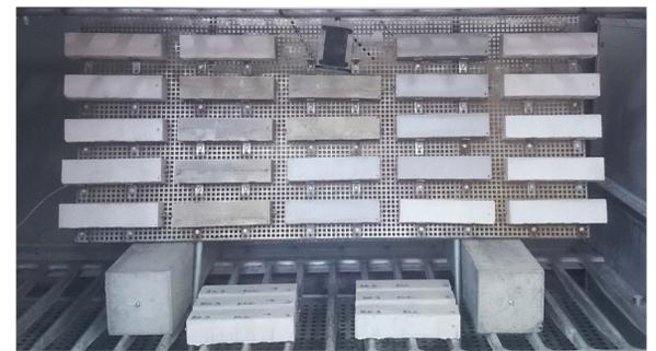
Abb. 2: Anordnung der Probekörper in der Klimakammer
