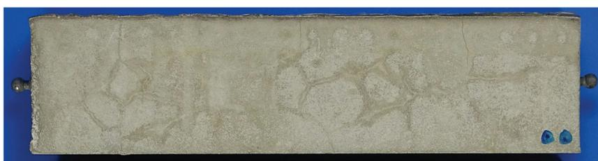
Abb. 5: Probekörper mit oberflächlichen Rissen nach Klimawechsellagerung
